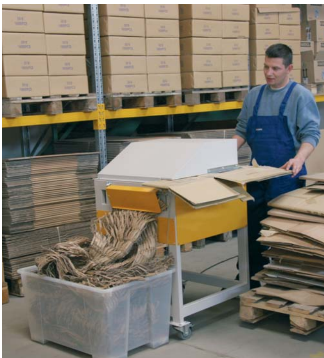
Maszyna Ekomet służy do produkcji materiału wypełniająco-amortyzującego metodą recyklingu odpadów kartonowych.
